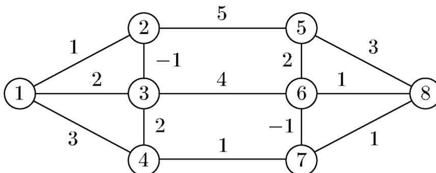
Применяя алгоритм Форда-Беллмана, определить кратчайшее расстояние между вершинами  $s = 5$  и  $t = 7$  (ПК – 5.3).
