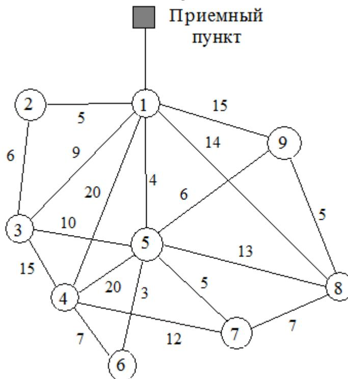
Применяя алгоритм Прима, постройте сеть трубопровода, соединяющего все скважины с приемным пунктом и имеющую минимальную общую длину труб (ПК – 5.3).
