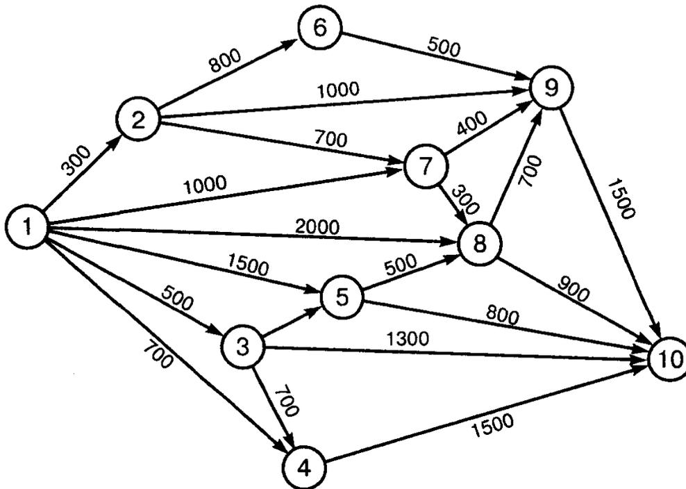
Применяя алгоритм Крускала, найдите такое соединение узла 1 с объектами строительства, чтобы суммарная длина трубопроводов была минимальной (ПК – 5.3).
