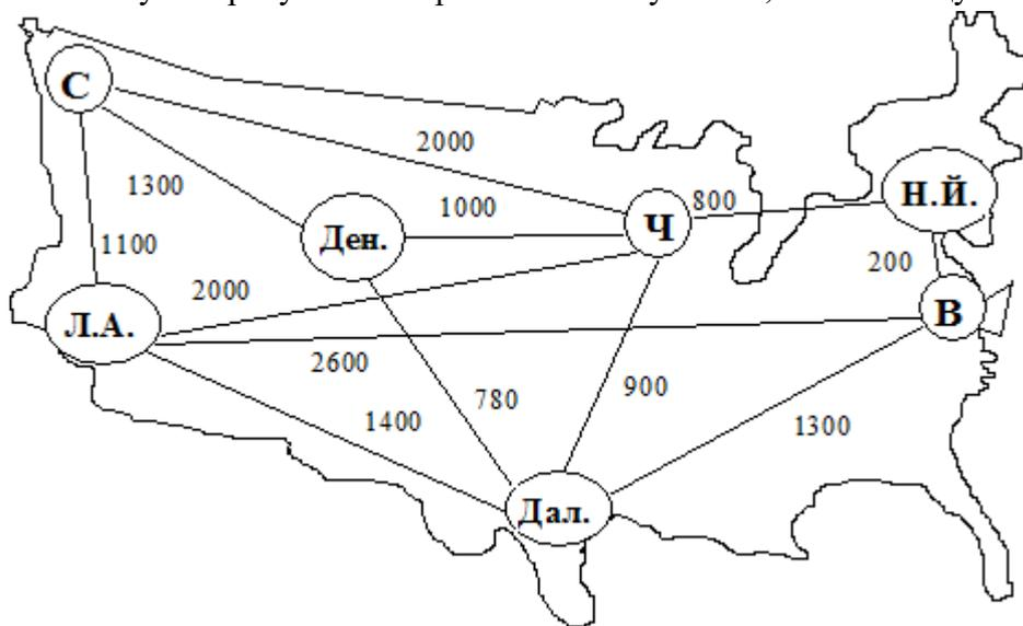
Применяя алгоритм Крускала, определите, какие города следует связать кабелем, с тем, чтобы получить минимальную общую длину коммуникаций (ПК – 5.3).
